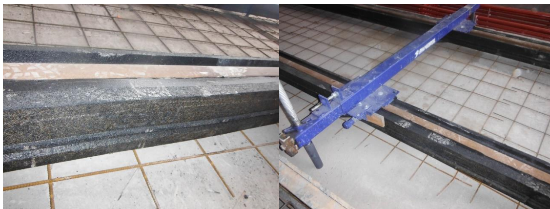
Снимка 14 Релси с уплътнения, които поглъщат шума и вибрациите.
